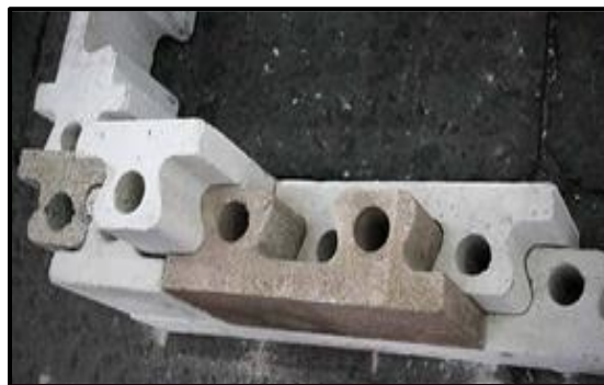
Ilustración 6 Sistema Constructivo Autoensamble
